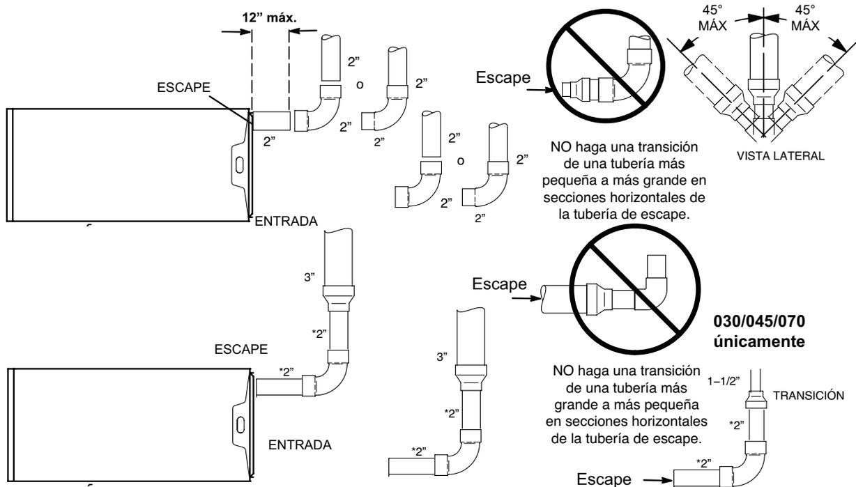
\* Durante la transición de aumento de tamaño de la tubería, use la sección más corta posible de tubería de PVC de 2".
