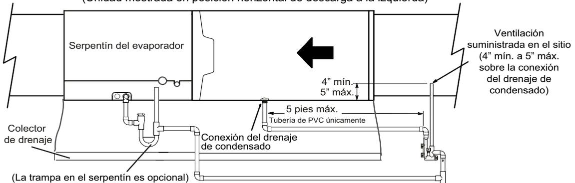
Desde el calefactor y serpentín del evaporador, la tubería se debe inclinar hacia abajo un mínimo de 1/4" por pie hacia la trampa
