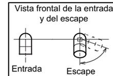
1 - El perfil en T de la terminación del escape debe conectarse a la tubería de combustión de PVC de 2" o 3" como se muestra en la ilustración. En las aplicaciones horizontales de perfil en T, debe haber un mínimo de 3 pies de distancia de los patios cubiertos y de las áreas interiores y no menos de 3 pies de una ventana. No usar un acelerador en aplicaciones que incluyen un perfil en T de terminación del escape. No se requiere acelerador.
