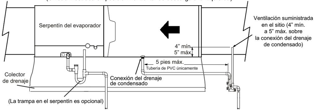
Desde el calefactor y serpentín del evaporador, la tubería se debe inclinar hacia abajo un mínimo de 1/4" por pie hacia la trampa
