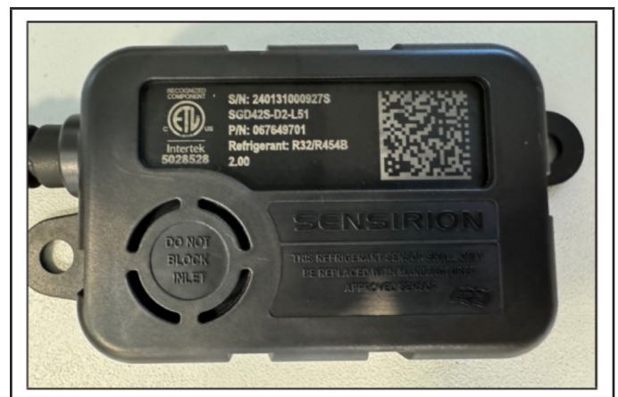
FIGURE 29. Exemple d'entrée de capteur dégagée et non bouchée
