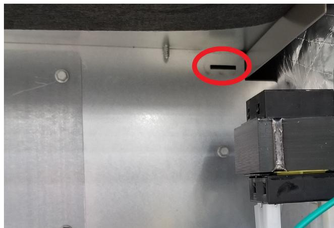
FIGURE 12. Fente pour le déplacement du panneau du contrôleur
