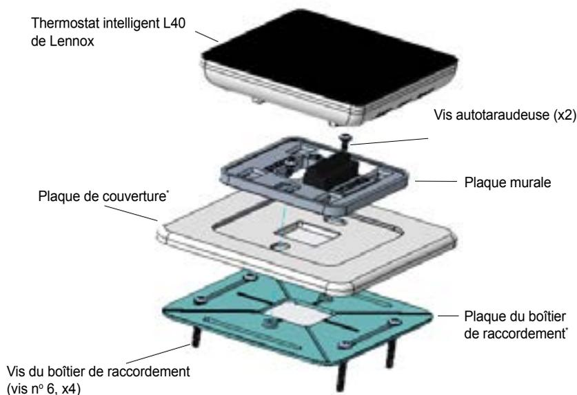
Figure 1. Vue éclatée - Composants du thermostat
