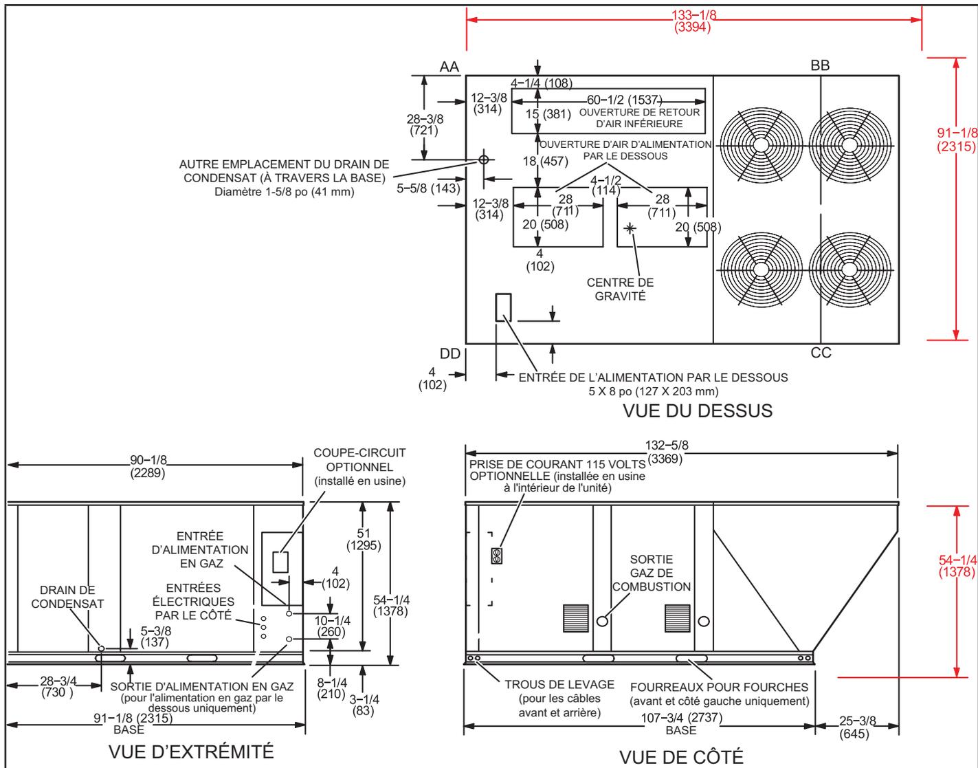
**LGT/LCT240H, 300H Dimensions de l'unité - pouces (mm) - Section de chauffage au gaz représentée**
