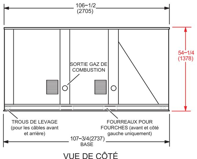
**LGT/LCT180H, 210H Dimensions de l'unité - pouces (mm) - Section de chauffage au gaz représentée**
