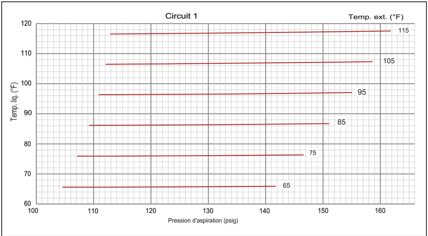
LGT/LCT 156 RÉCHAUFFAGE - COURBE DE CHARGE CIRCUIT 2 - SERPENTIN EXT. TOUT EN ALUMINIUM - 581084-02
