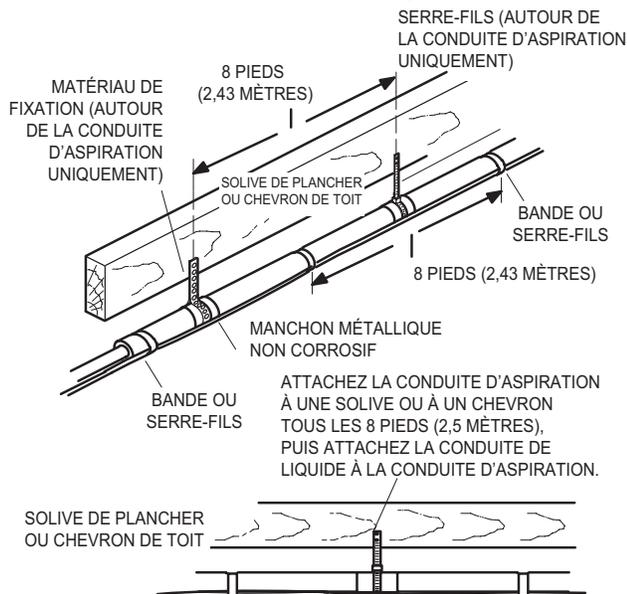
**REMARQUE** – Suivez des pratiques d'installation similaires pour l'installation à l'extérieur d'un mur extérieur.
