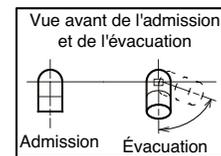
1 - La terminaison d'évacuation en T doit être connectée au conduit d'évacuation en PVC de 2 po ou 3 po comme indiqué sur l'illustration. Sur les applications à T horizontal, il doit y avoir un minimum de 3 pi des patios couverts ou de toute zone habitée et ne peut pas être à moins de 3 pi d'une fenêtre. N'utilisez pas d'accélérateur dans les applications qui incluent une terminaison d'évacuation en T. L'accélérateur n'est pas obligatoire.
