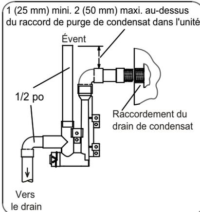
Ensemble drain/piège avec tuyau de 3/4 po
