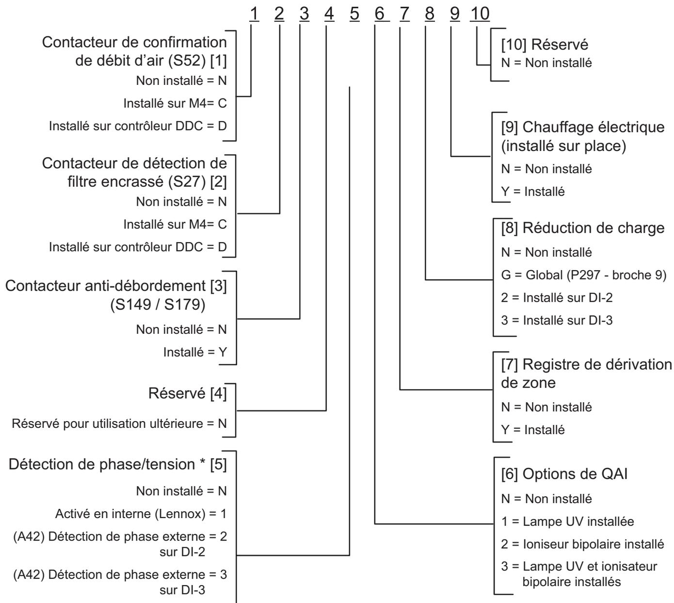
\* Si la détection de phase et la surveillance de la tension sont activées et incorrectement câblées, le système passe en mode de maintien de la demande et redémarre au bout de six minutes.
