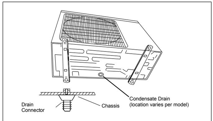
**Figure 30. Condensate Drain**
