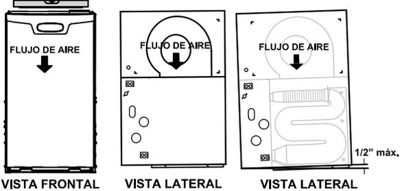
La unidad se debe nivelar de lado a lado. La unidad puede posicionarse desde el nivel hasta 1/2" hacia el frente para ayudar con el drenaje.
