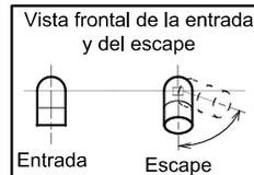
1 - El codo de 45° de la tubería de escape puede girarse hacia el lado alejado de la entrada de aire de combustión para dirigir el escape lejos de la propiedad adyacente. El escape nunca se debe dirigir hacia la entrada de aire de combustión.
