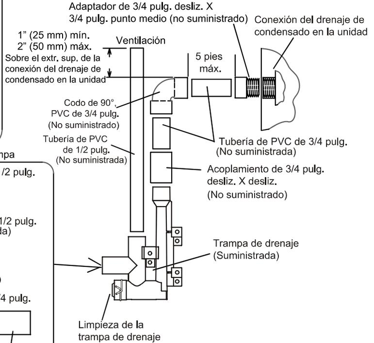
Ensamble de trampa de condensado con tubería de 1/2 pulg.
