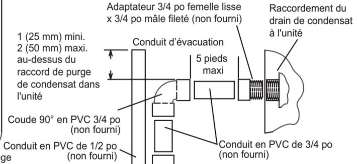
Conduit de drainage optionnel depuis le piège
