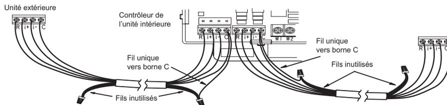
Les systèmes communicants utilisant un thermostat communicant nécessitent quatre fils de thermostat entre le thermostat et le contrôleur du générateur d'air chaud/ventilo-convecteur, et quatre fils entre l'unité extérieure et le contrôleur du générateur d'air chaud/ventilo-convecteur. Si un câble de thermostat avec plus de quatre fils est utilisé, les fils supplémentaires doivent être correctement connectés pour éviter tout bruit électrique. Les fils ne doivent pas être laissés déconnectés.
