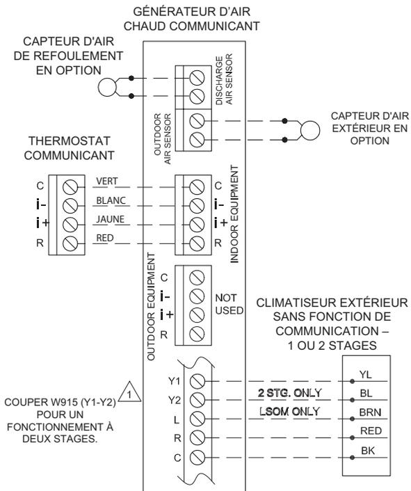
**Générateur d'air chaud communicant et unité extérieure communicante**
