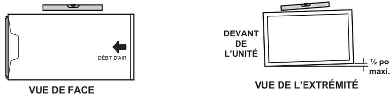
L'unité doit être de niveau transversalement. L'unité peut s'écarter de l'horizontale de 0,5 po vers l'avant pour faciliter le drainage.
