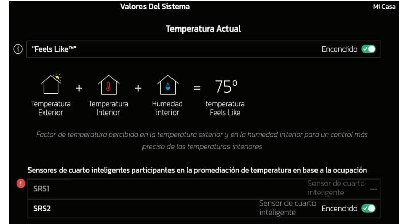
Figura 17. Pantalla de Feels Like™ con los sensores de cuarto inteligentes seleccionados
