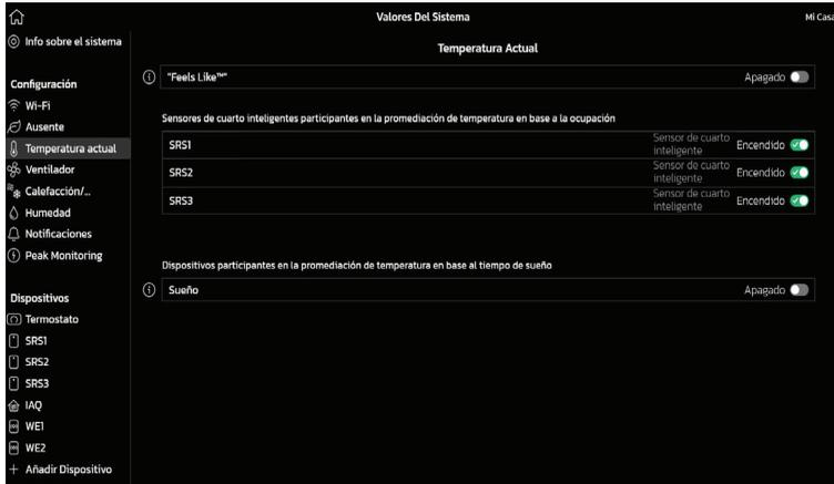
Figura 20. Configuración de ocupación para el promedio de temperatura
