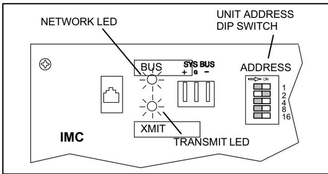
**Figure 3. IMC LEDs**
