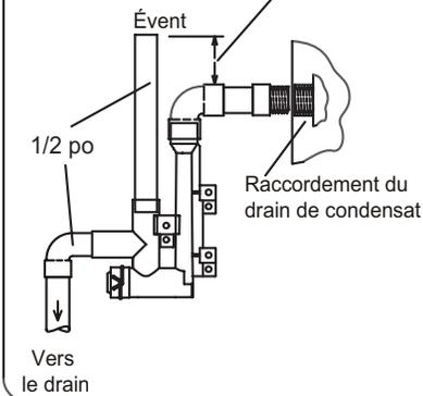
Ensemble drain/piège avec tuyau de 3/4 po
