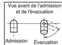
1 - La terminaison d'évacuation en T doit être connectée au conduit d'évacuation en PVC de 2 po ou 3 po comme indiqué sur l'illustration. Sur les applications à T horizontal, il doit y avoir un minimum de 3 pi des patios couverts ou de toute zone habitée et ne peut pas être à moins de 3 pi d'une fenêtre. N'utilisez pas d'accélérateur dans les applications qui incluent une terminaison d'évacuation en T. L'accélérateur n'est pas obligatoire.
