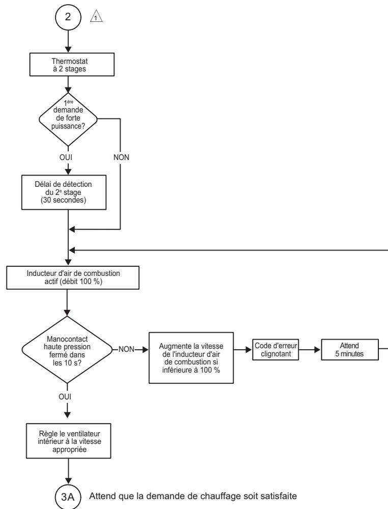
△1 Le système s'allume toujours à 70 % même si une demande de chauffage de 2e stage est active.
