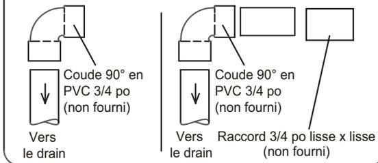
Ensemble drain/piège avec tuyau de 1/2 po
