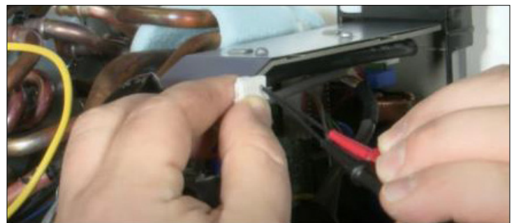
Figure 35. Testez avec des pointes de touche fines sur les 2 pattes argentées
