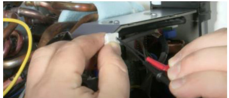
Testez avec des pointes de touche fines sur les 2 pattes argentées
