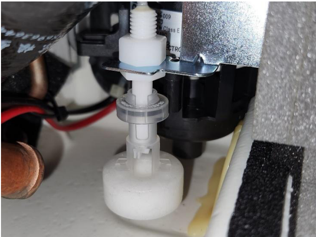
Inspectez le contacteur à flotteur et le niveau d'eau
