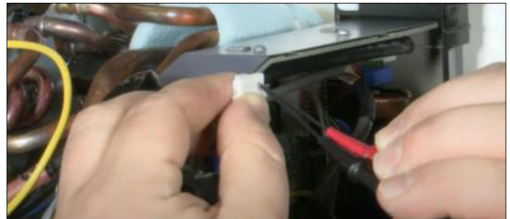
Figure 37. Testez avec des pointes de touche fines sur les 2 pattes argentées
