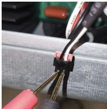
Vérifiez la continuité au niveau du port du capteur
