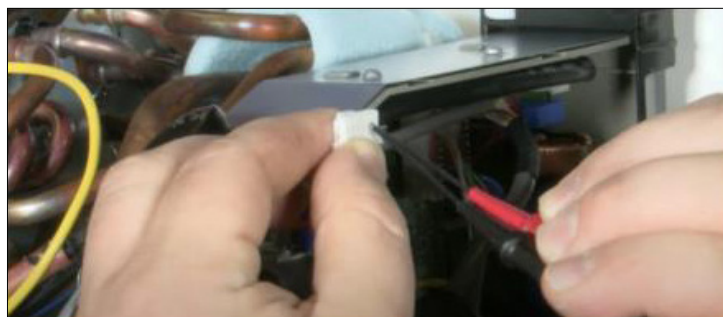
Testez avec des pointes de touche fines sur les 2 pattes argentées
