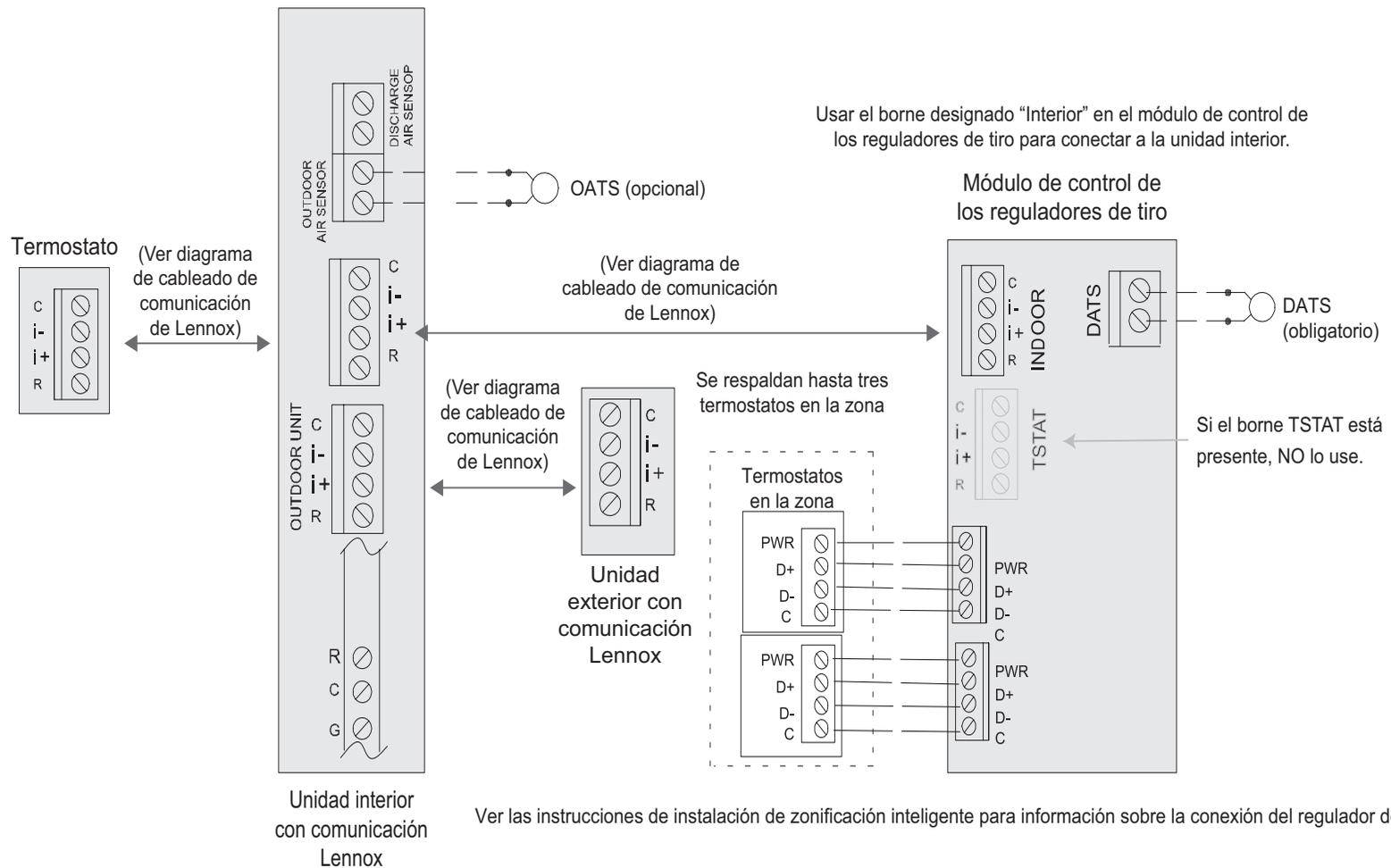
**Figura 8. S40 Lennox, unidades interiores y exteriores con comunicación Lennox, sistema de zonificación inteligente (módulo de control del regulador de tiro) y sensores de zonas**
