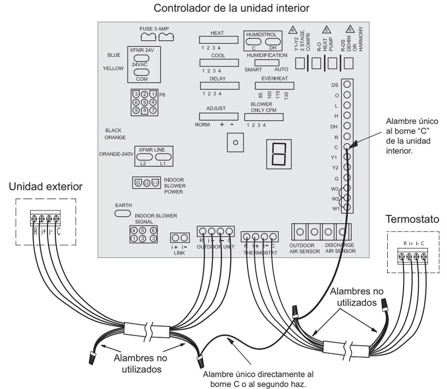
Figura 5. Reducción al mínimo del ruido eléctrico
