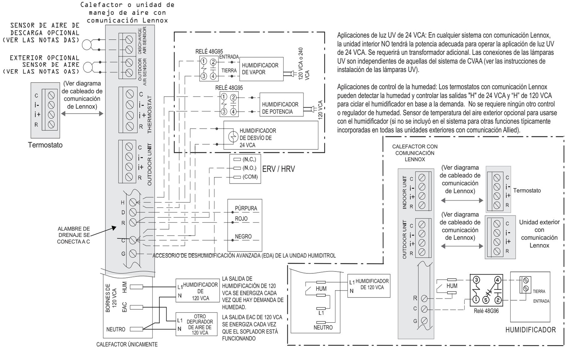
Aplicaciones de luz UV de 24 VCA: En cualquier sistema con comunicación Lennox, la unidad interior NO tendrá la potencia adecuada para operar la aplicación de luz UV de 24 VCA. Se requerirá un transformador adicional. Las conexiones de las lámparas UV son independientes de aquellas del sistema de CVAA (ver las instrucciones de instalación de las lámparas UV).
