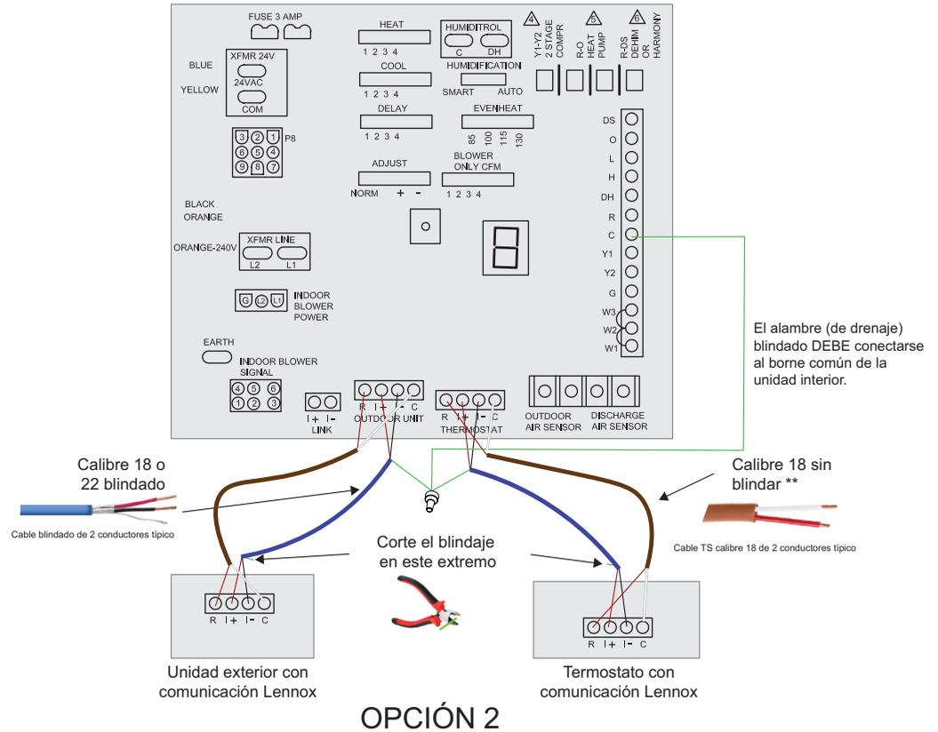
**Figura 3. Conexiones de cableado del sistema con comunicación Lennox usando cable sin blindar (Opción 1) o blindado (Opción 2)**
