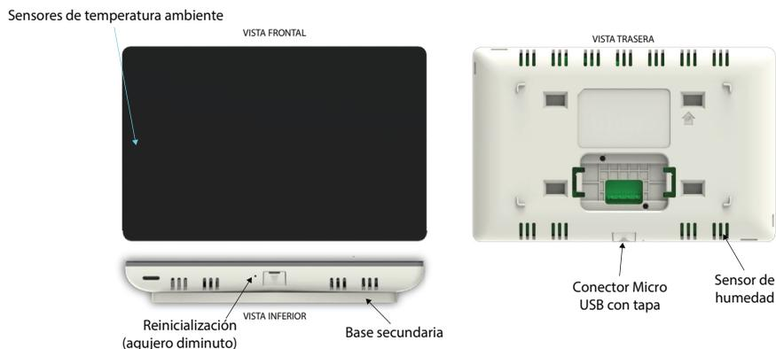
Figura 1. Componentes externos del termostato
