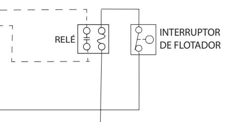
Figura 12. S40 Lennox, controles interiores con comunicación Lennox e interruptor de flotador
