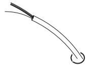
Selle el agujero en la pared para impedir que el aire frío o caliente afecte el sensor de temperatura en la pantalla.
