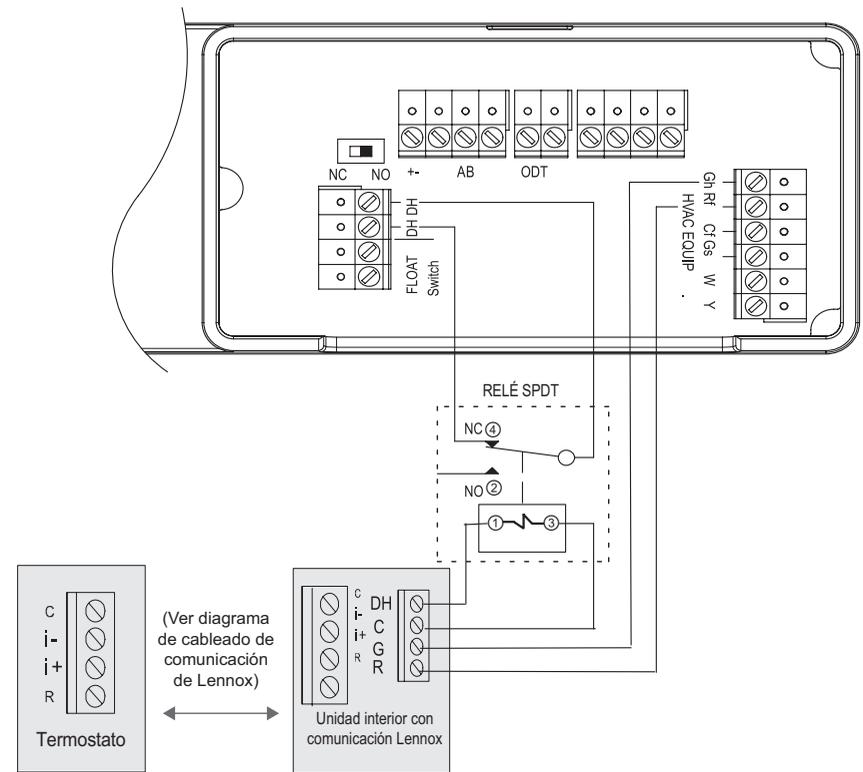
**Figura 7. S40 Lennox, control interior con comunicación (conexiones convencionales), relé y deshumidificadores Serie HCWHD4**
