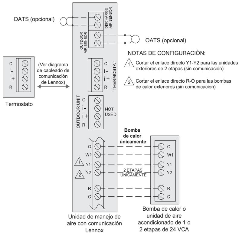
**Figura 6. S40 Lennox, unidad de manejo de aire con comunicación Lennox con bomba de calor de 24 VCA (de 1 o 2 etapas) o unidad de aire acondicionado**
