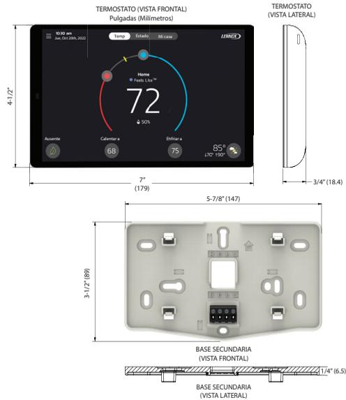
Figura 2. Termostato y base secundaria
