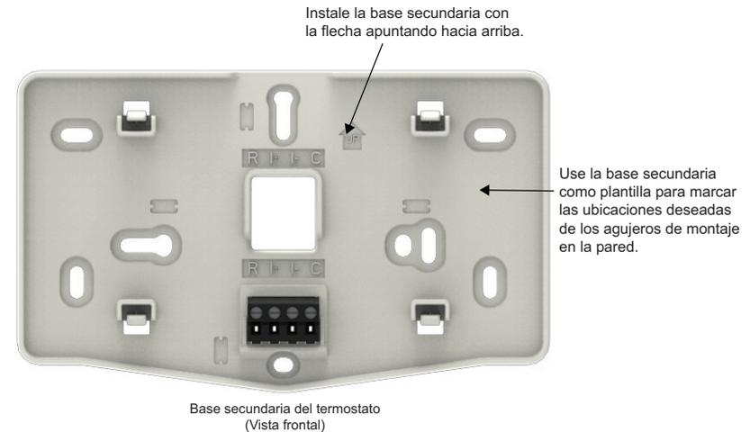
9. Taladre agujeros de 3/16" (5 mm) en las ubicaciones marcadas en la pared para los dispositivos de anclaje. Entonces inserte los dispositivos de anclaje de pared en los agujeros hasta que queden a ras con la pared.
