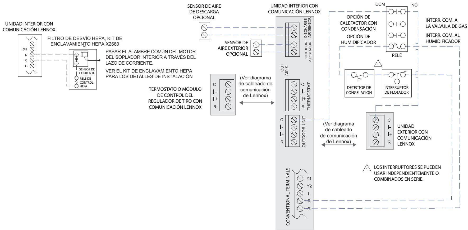
Figura 11. Kit de enclavamiento de S40 Lennox y filtro de desvío HEPA y humidificador
