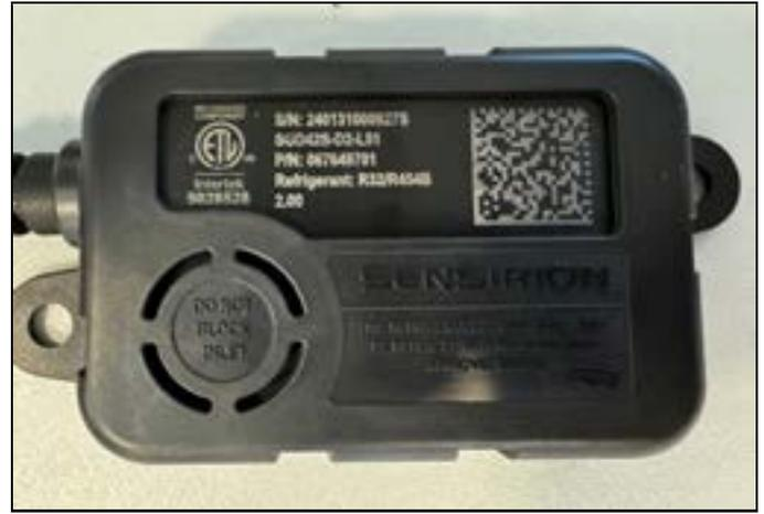
**FIGURA 10. Ejemplo de entrada del sensor libre y sin obstrucciones**
