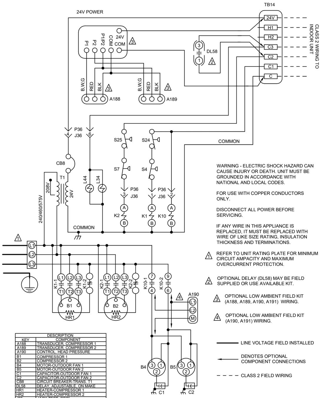
**WARNING - ELECTRIC SHOCK HAZARD CAN CAUSE INJURY OR DEATH. UNIT MUST BE GROUNDED IN ACCORDANCE WITH NATIONAL AND LOCAL CODES.**
