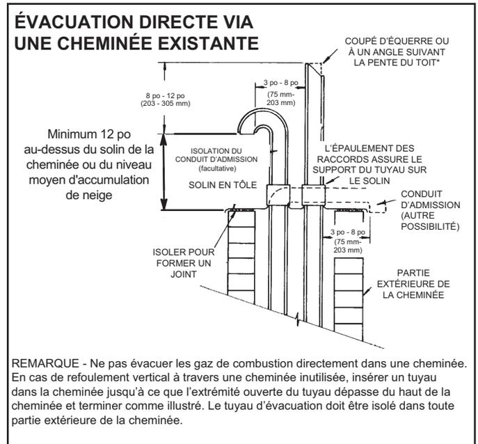
REMARQUE - Ne pas évacuer les gaz de combustion directement dans une cheminée. En cas de refoulement vertical à travers une cheminée inutilisée, insérer un tuyau dans la cheminée jusqu'à ce que l'extrémité ouverte du tuyau dépasse du haut de la cheminée et terminer comme illustré. Le tuyau d'évacuation doit être isolé dans toute partie extérieure de la cheminée.
