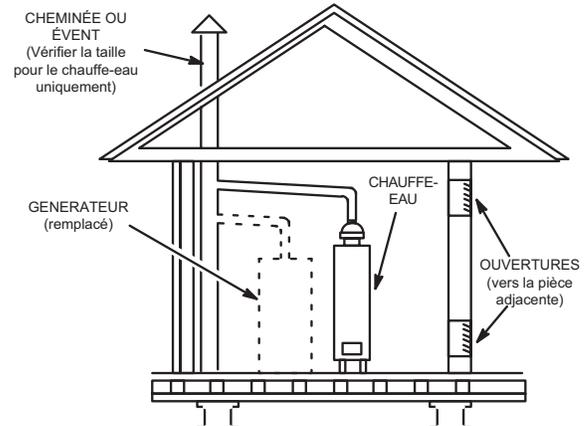
Si le générateur d'air chaud remplace un appareil qui partageait le conduit d'évacuation avec un autre appareil au gaz, il faut vérifier le diamètre du conduit. Sans la chaleur générée par les gaz d'évacuation de l'appareil de chauffage d'origine, le conduit d'évacuation existant est probablement surdimensionné pour la capacité du chauffe-eau ou de l'autre appareil seul. Le tirage du conduit d'évacuation doit être contrôlé avec l'appareil restant.
