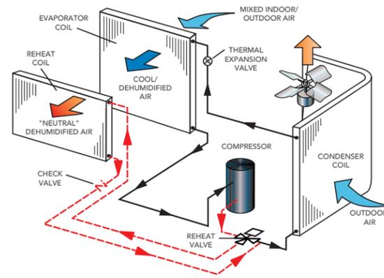
**HUMIDITROL DEHUMIDIFICATION SYSTEM FOR LENNOX ROOFTOP UNITS**
