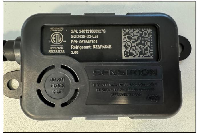
**FIGURA 11. Ejemplo de entrada del sensor libre y sin obstrucciones**
