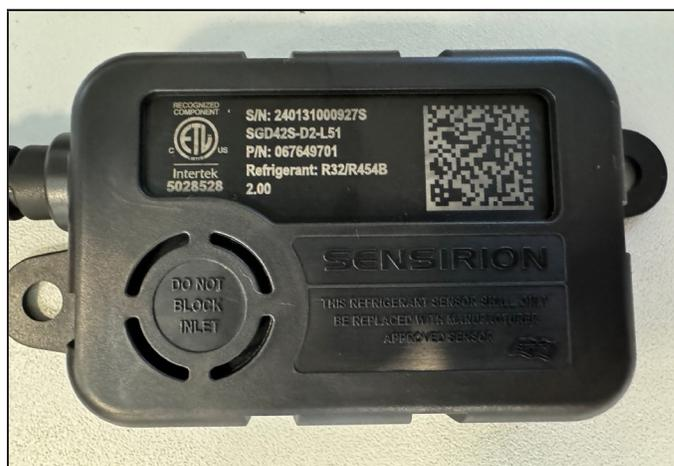
**FIGURE 36. Exemple d'entrée de capteur dégagée et non bouchée**
