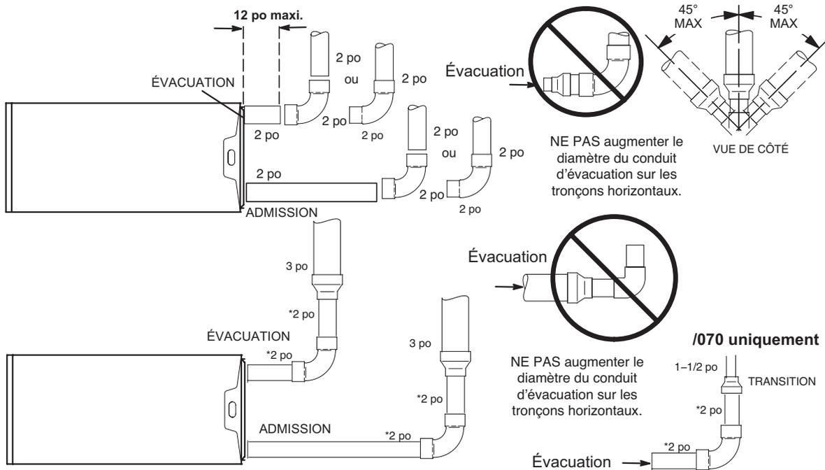
\* Pour passer à un tuyau de plus grand diamètre, utiliser la longueur de tuyau en PVC de 2 po la plus courte possible.
