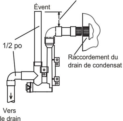
Ensemble drain/piège avec tuyau de 3/4 po
