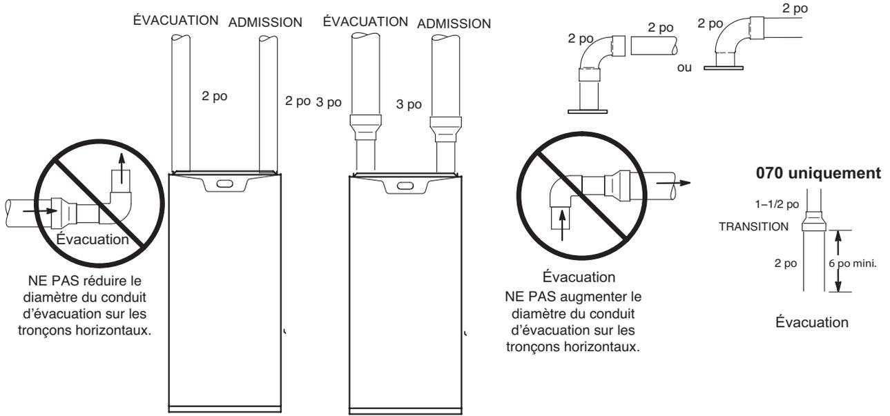
\* Pour passer à un tuyau de plus grand diamètre, utiliser la longueur de tuyau en PVC de 2 po la plus courte possible.
