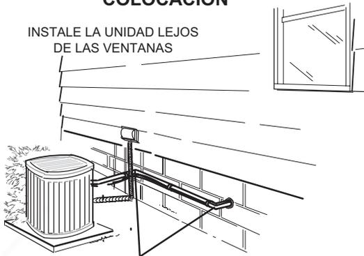
DOS CODOS DE 90° INSTALADOS EN EL CONJUNTO DE LÍNEAS AYUDAN A REDUCIR LA VIBRACIÓN DEL CONJUNTO
