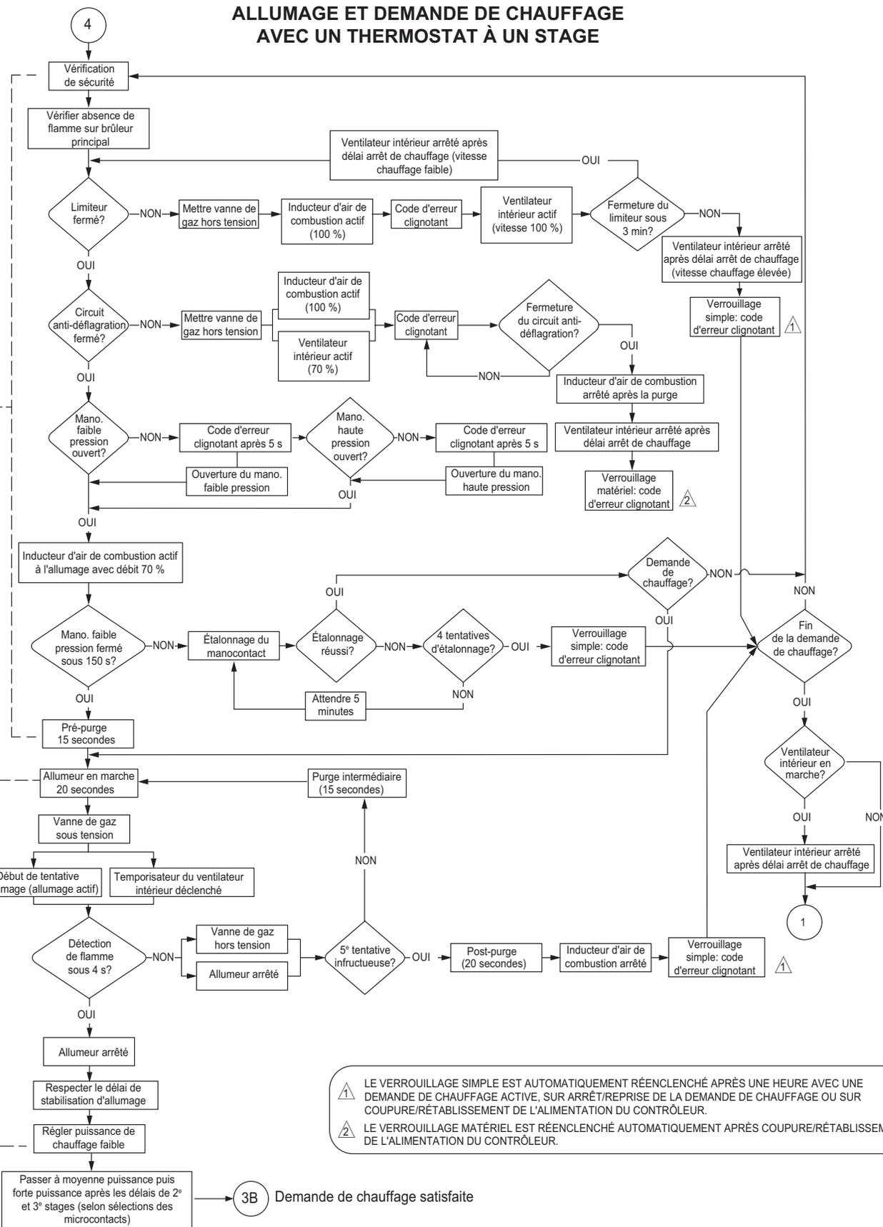
⚠ LE VERROUILLAGE SIMPLE EST AUTOMATIQUEMENT RÉENCLENCÉ APRÈS UNE DEMANDE DE CHAUFFAGE ACTIVE, SUR ARRÊT/REPRISE DE LA DEMANDE DE CHAUFFAGE OU SUR COUPURE/RÉTABLISSEMENT DE L'ALIMENTATION DU CONTRÔLEUR.
