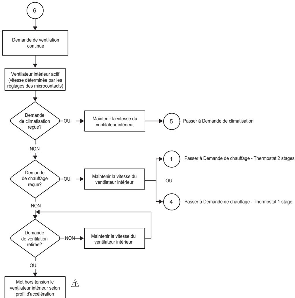
⚠ Les modes Climatisation faible puissance et Climatisation forte puissance du ventilateur intérieur présentent des profils d'allumage/arrêt et d'augmentation particuliers. Le profil requis est sélectionné à l'aide des microcontacts du contrôleur.
