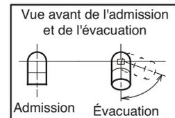
1 - La terminaison d'évacuation en T doit être connectée au conduit d'évacuation en PVC de 2 po ou 3 po comme indiqué sur l'illustration. Sur les applications à T horizontal, il doit y avoir un minimum de 3 pi des patios couverts ou de toute zone habitée et ne peut pas être à moins de 3 pi d'une fenêtre. N'utilisez pas d'accélérateur dans les applications qui incluent une terminaison d'évacuation en T. L'accélérateur n'est pas obligatoire.
