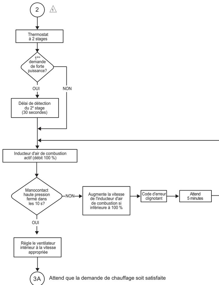
⚠ Le système s'allume toujours à 70 % même si une demande de chauffage de 2e stage est active.
