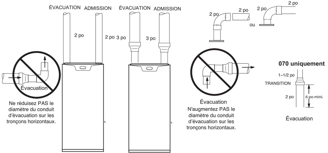
\* Pour passer à un tuyau de plus grand diamètre, utilisez la longueur de tuyau en PVC de 2 po la plus courte possible.
