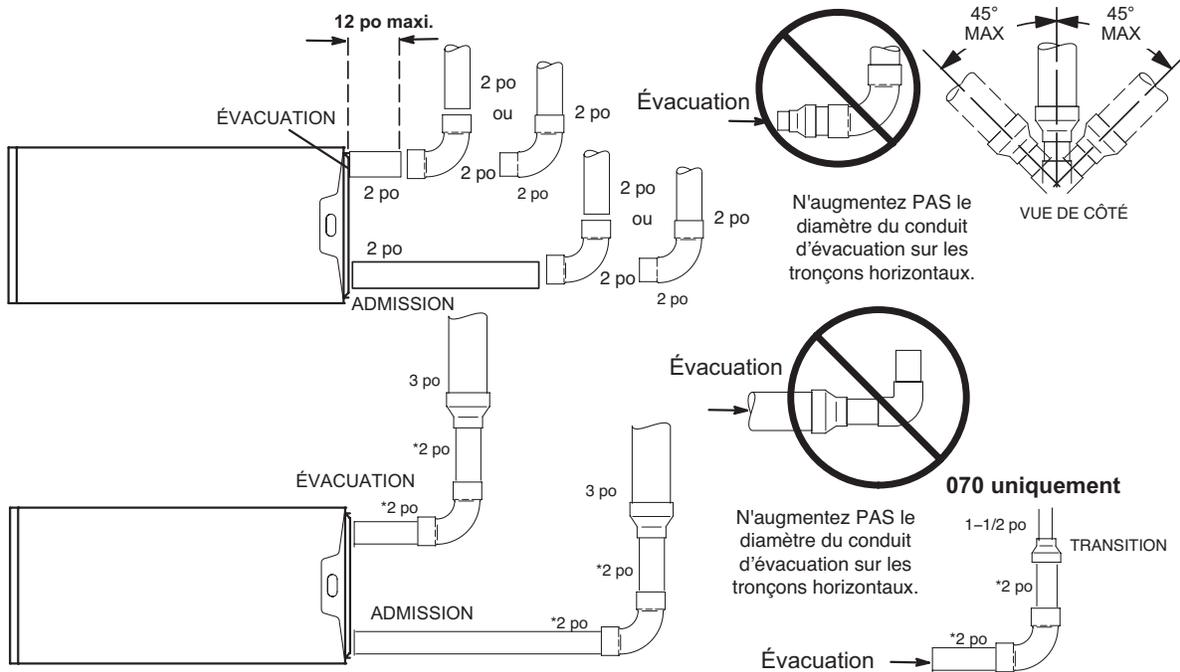
\* Pour passer à un tuyau de plus grand diamètre, utilisez la longueur de tuyau en PVC de 2 po la plus courte possible.
