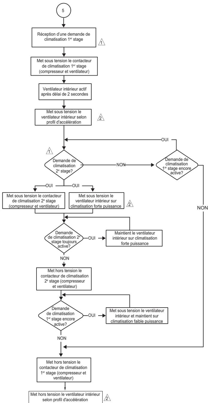
⚠ La climatisation de 2<sup>e</sup> stage nécessite un thermostat à 2 stages, un système de climatisation à 2 stages et la coupure de la connexion W915 sur le contrôleur. Le contrôleur doit répondre à une demande de climatisation de 2<sup>e</sup> stage, sauf si une demande de climatisation de 1er stage est active.
